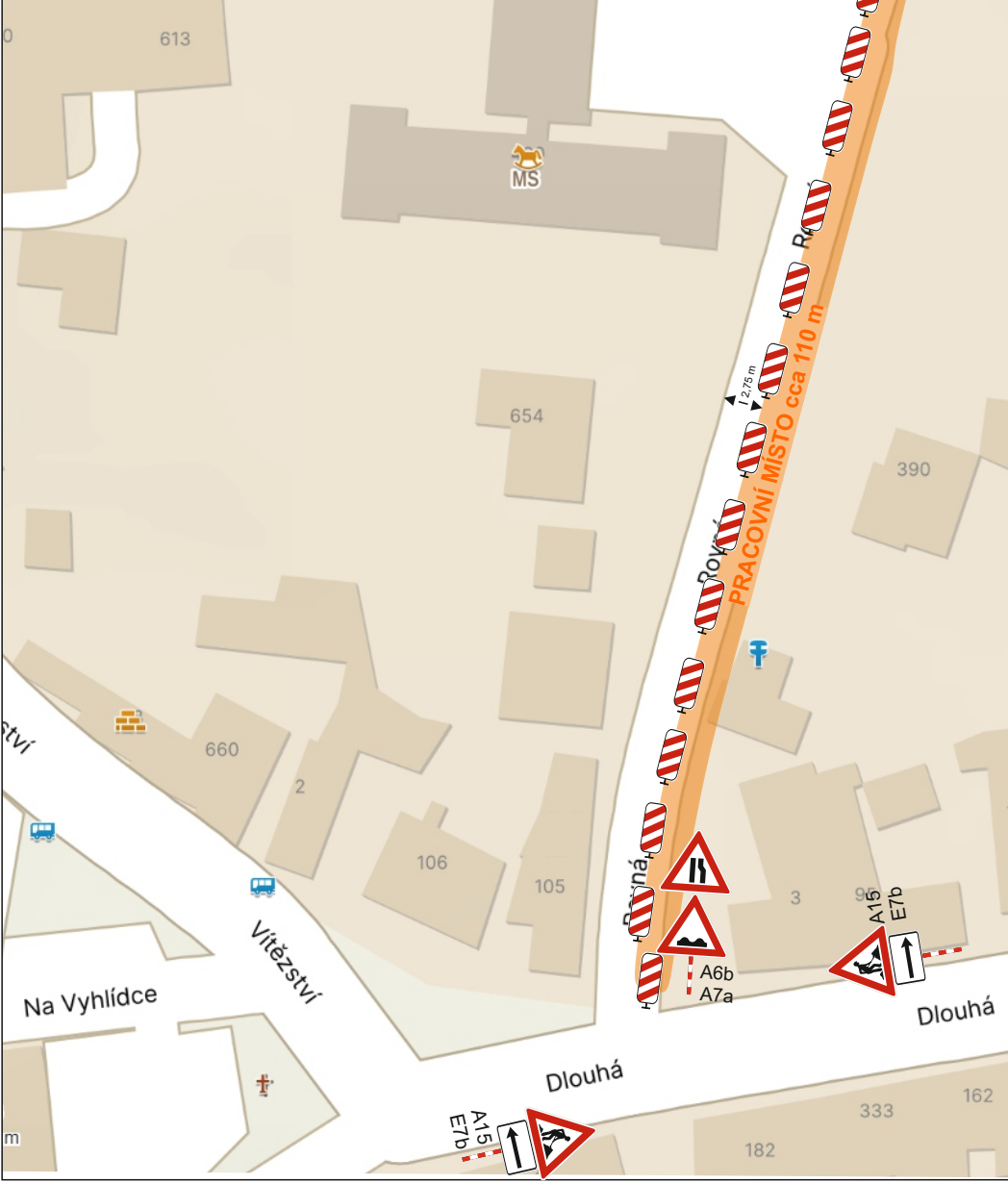
SITUACE DZ - ul. Rovná - částečná uzavírka I.etapa
