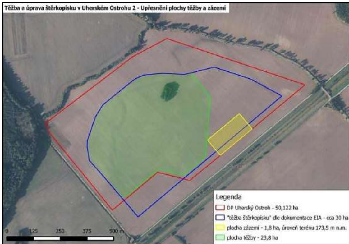
Obr. 14: Těžba a úprava štěrkopísku v Uherském Ostrohu 2 s upřesněním plochy těžby a zázemí.
